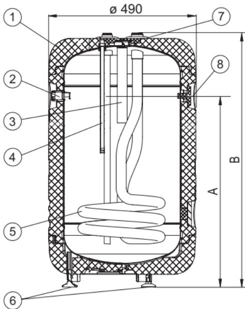
ZW- холодная вода (трубка PEX-AL-PEX)
