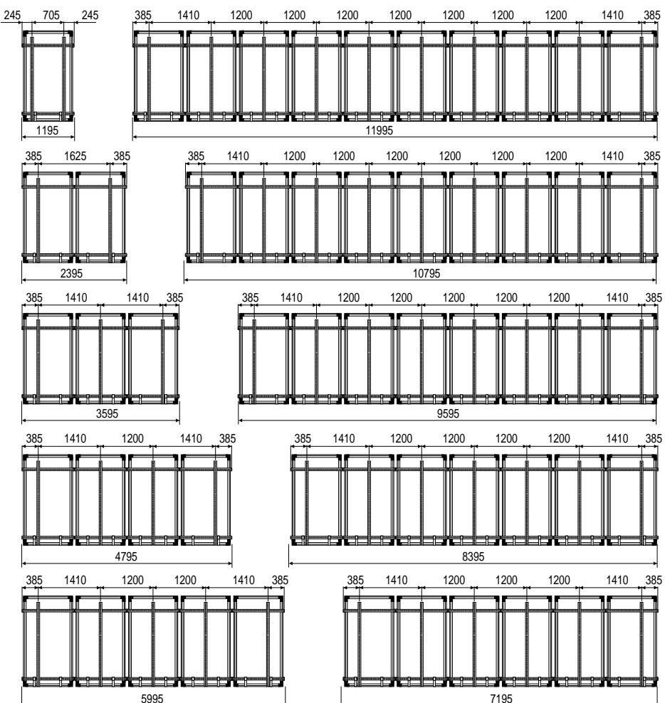
A : ΣΥΝΙΣΤΟΜΕΝΑ ΣΗΜΕΙΑ ΣΤΗΡΙΞΗΣ ΚΑΤΩ ΑΠΟ ΚΑΝΟΝΙΚΕΣ ΣΥΝΗΓΡΕΣ ΦΟΡΤΟΥ (1,2kN/m<sup>2</sup> χιονού, 28m/s αέρα -100km/h).
