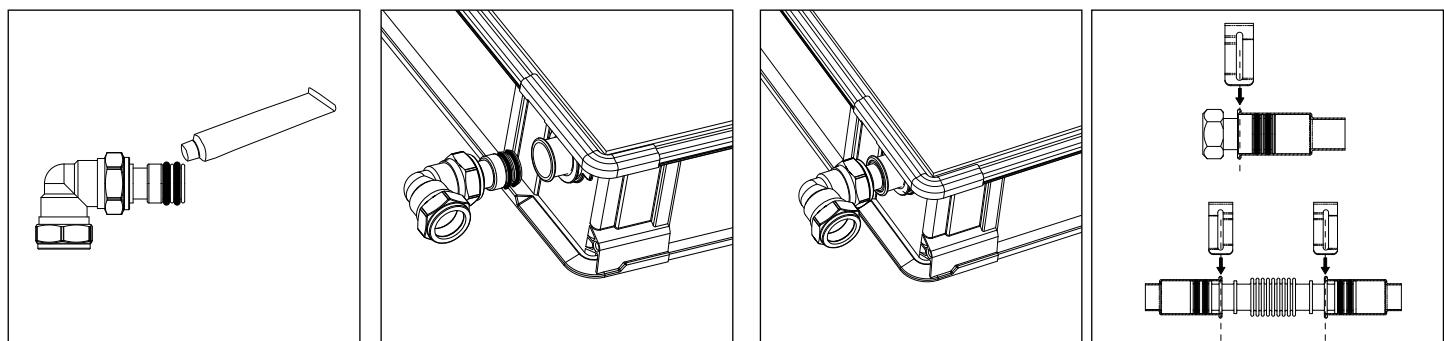
Ασφαλίστε το εξάρτημα χρησιμοποιώντας το κλίπ στερέωσης. Βάλτε τον σωλήνα (μαλακός 22 mm) στο εξάρτημα και σφίξτε. Μετά μονώστε τον σωλήνα και το εξάρτημα.
