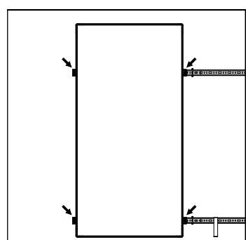
Av πρέπει να εγκατασταθεί ακόμη ένας συλλέκτης, βάλτε ακόμη ένα κλίπ στερέωσης σε κάθε οριζόντια μπάρα, εξασφαλίζοντας ότι έρχεται σε επαφή με αυτό που εγκαταστάθηκε προηγουμένως και κάνοντας τις διαδικασίες με τον πρώτο συλλέκτη.
