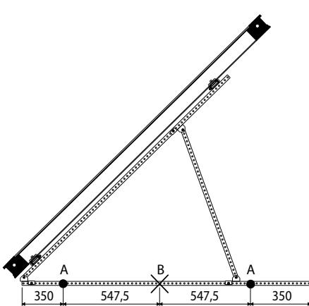
A : ΣΥΝΙΣΤΩΜΕΝΑ ΣΗΜΕΙΑ ΣΤΗΡΙΞΗΣ ΚΑΤΩ ΑΠΟ ΚΑΝΟΝΙΚΕΣ ΣΥΝΘΗΚΕΣ ΦΟΡΤΙΟΥ (1,2KN/M<sup>2</sup> χιονιού, 28m/s αέρα -100Km/h).
